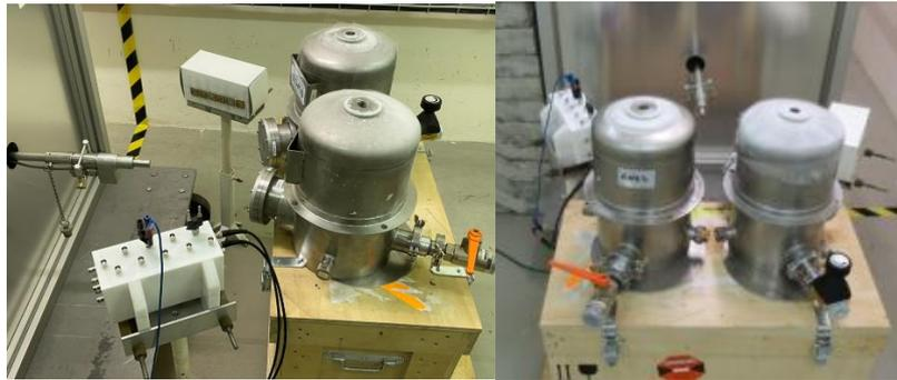
Figure 61 : Cryostat et échantillons irradiés par la source isotrope Cobalt 60 dans le bunker MEGA de l'ONERA.
