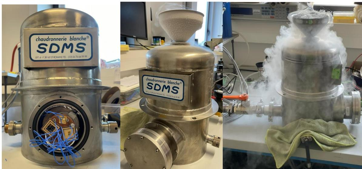
Figure 52 : Préparation du cryostat pour une campagne d'irradiation.
