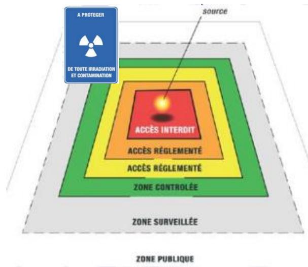
Figure 123 : Zones en fonction de la distance avec la source radioactive
