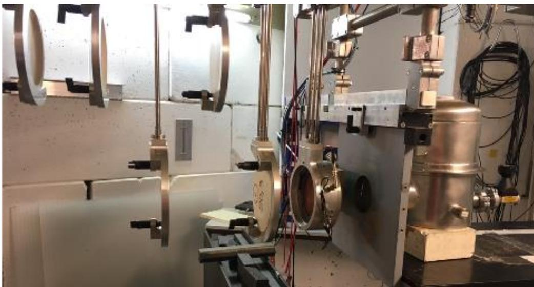
Figure 55 : Set up pour obtenir une énergie de protons de 30 MeV arrivant sur le cryostat.
