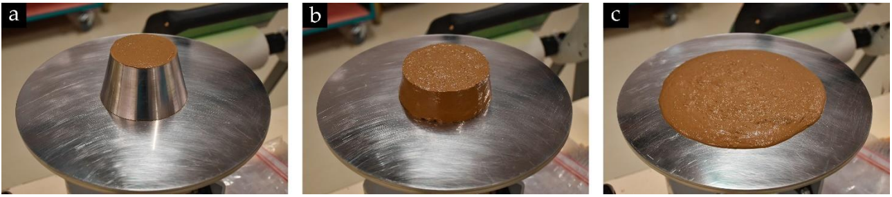
Fig. 62. (a) Moule en forme de cône rempli du matériau posé sur le plateau de la table à chocs ; (b) Mélange sol-ciment après avoir enlevé le moule ; (c) Galette de matériau DSM formée après avoir tourné la manivelle 15 fois en 15 secondes (étalement = 17,4 cm)
