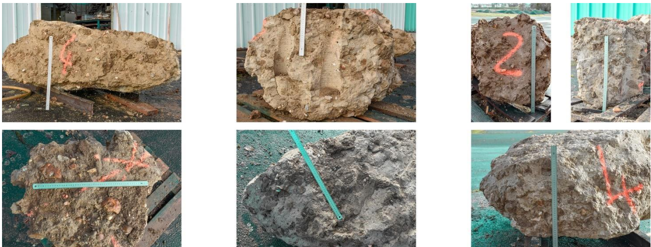
Fig. 334. Quelques photos des sous-blocs dont la distribution de taille d'inclusions de sol et de graviers a été analysée manuellement et par traitement d'images (© J. Amrioui)
