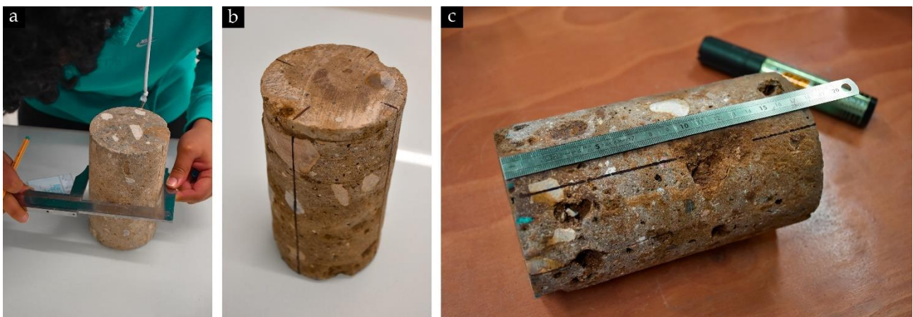
Fig. 295. (a) Mesure des dimensions de l'éprouvette à l'aide d'un pied à coulisse ; (b) Quatre lignes de mesure tracées autour de l'éprouvette ; (c) Mesure de la longueur cumulée des inclusions à l'aide d'une règle graduée
