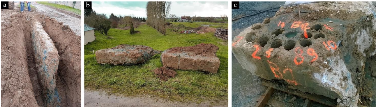
Fig. 333. (a) Excavation sur les côtés de l'écran étanche en DSM ; (b) Deux blocs en DSM prélevés ; (c) Carottage d'une série d'éprouvettes dans le sens de l'épaisseur de l'écran [© Université Gustave Eiffel (ex. IFSTTAR) & Cerema]
