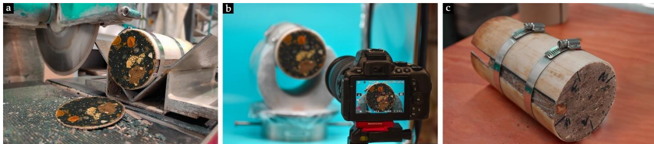
Fig. 135. (a) Découpe des éprouvettes en tranches de 3 mm à l'aide d'une scie à matériaux sous l'eau ; (b) Acquisition d'images à l'aide d'un appareil photo numérique ; (c) Système de maintien conçu pour maintenir en place les éprouvettes ayant subi l'essai de résistance à la compression simple R_c
