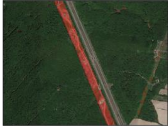
Image 2 : Emprise d'une ligne électrique.
