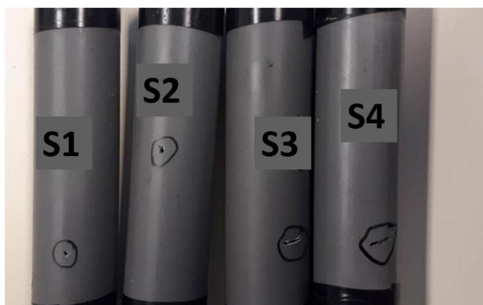
**Figure 3.20.** Échantillons pour différentes fuites : S1(1 mm), S2(2 mm), S3(4 x 1 mm<sup>2</sup>), S4(10 x 1 mm<sup>2</sup>)
