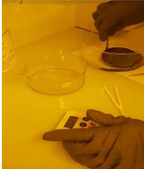
**Figure 2.17.** Principe de développement de la résine
