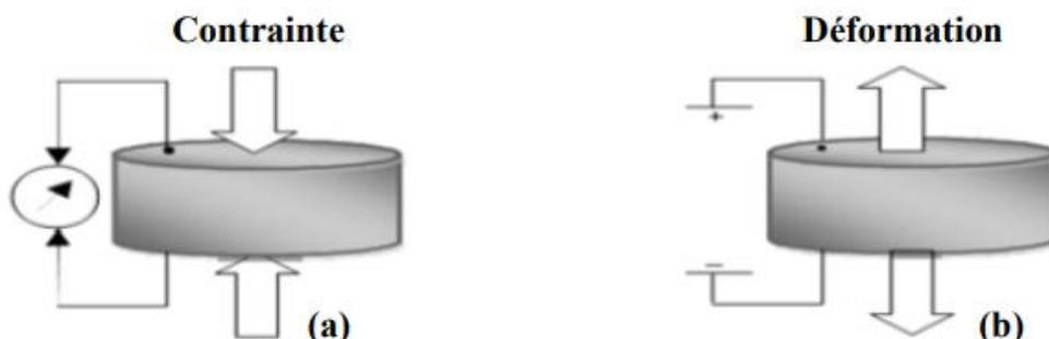
Figure 1.1. Principe de la piézoélectricité
