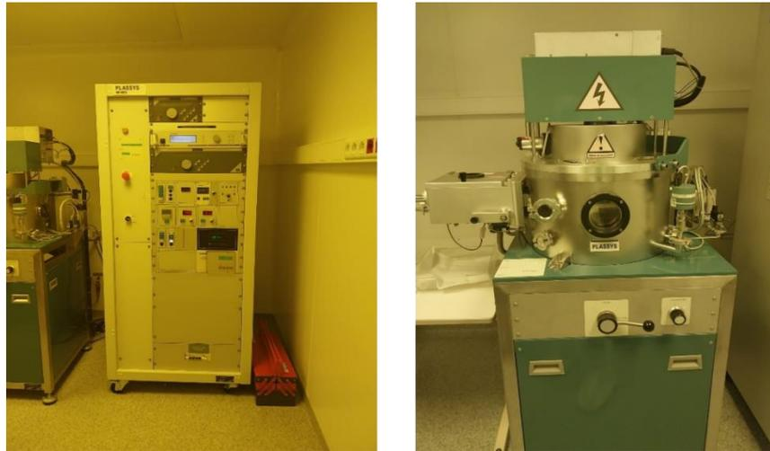
Figure 2.18. Dispositif de pulvérisation cathodique PLASSYS MP 450S
