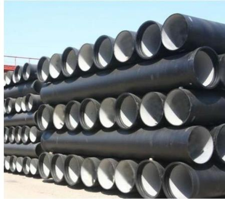
**Figure 3.6.** Canalisation en fonte ductile
