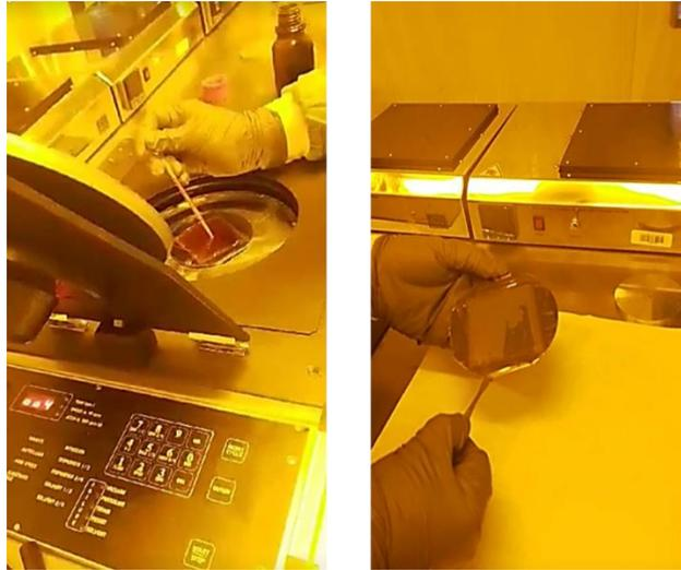
**Figure 2.15.** Principe de déposition et de séchage de la résine AZ5214 sur la surface du substrat
