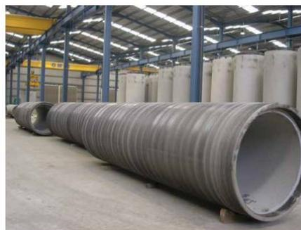
**Figure 3.7.** Canalisation en béton à âme en tôle
