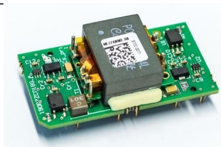
Figure 1-2 : Photographie d'un prototype de CSC DC-DC développé au laboratoire dans le cadre de la thèse de Théo Lamorelle [35].
