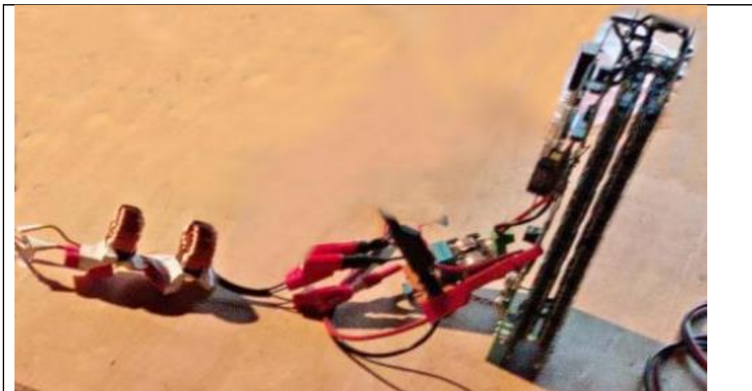
Figure 1-12 : Photographie d’un PCA avec son filtre de mode commun – environ 20% du volume –
