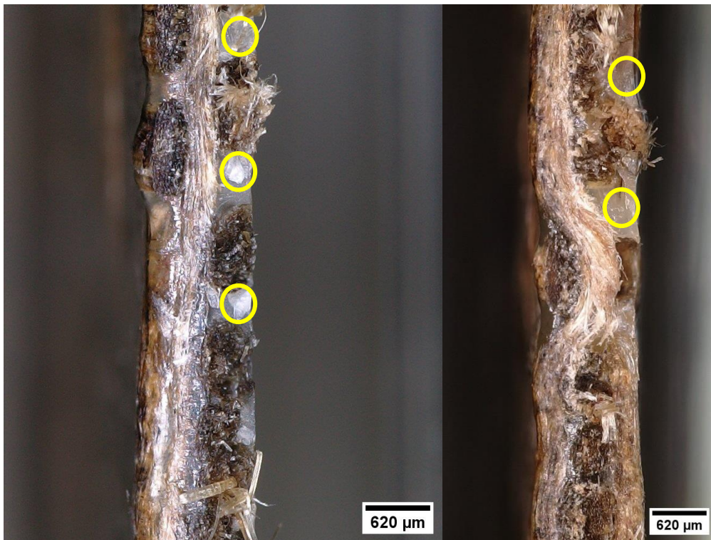
Figure 4-109: Faciès de rupture des éprouvettes après l'essai de traction avec une vue microscopique de la coupe transversale, a) composite CHPA11_5 et b) composite CHPA11_4
