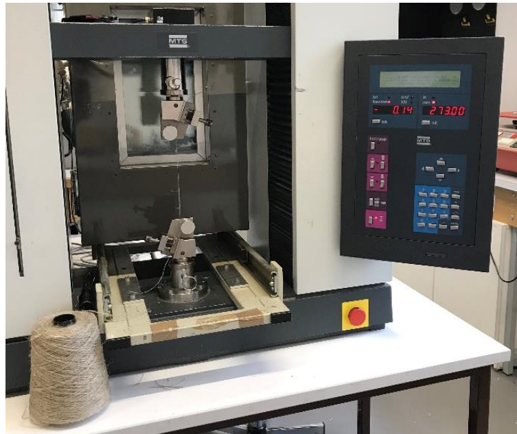
Figure 2-29: Banc de traction utilisé pour la caractérisation des mèches de chanvre
