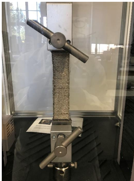
Figure 3-58: Essai de traction du renfort textile sur le Banc de traction MTS Criterion 45
