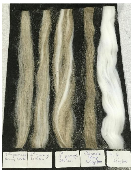
Figure 2-39: Aspect visuel du mélange chanvre/PLA après les différents passages sur le Gills
