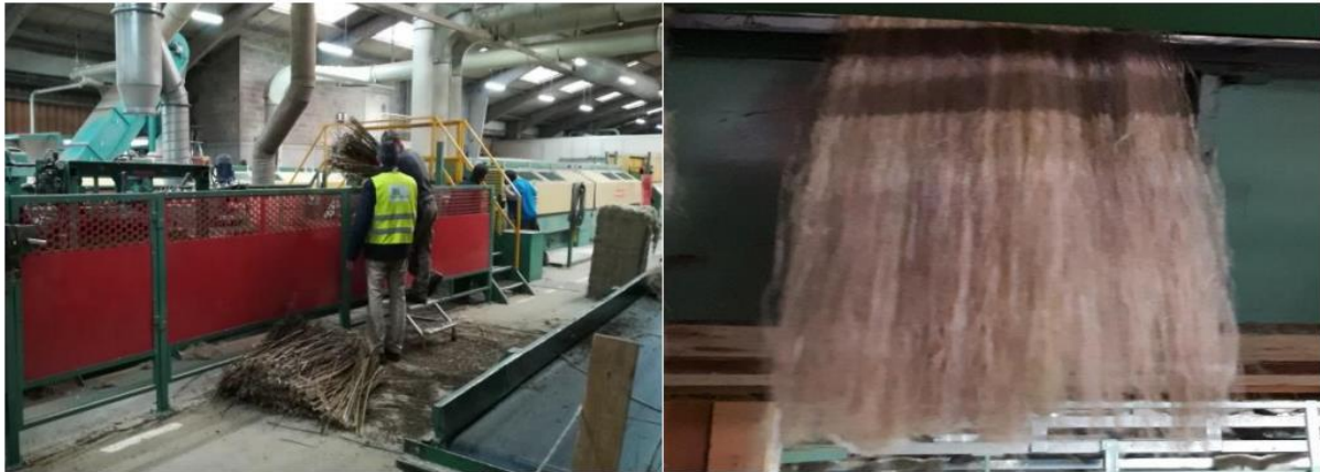
Figure 1-7 : Teillage et peignage du chanvre [25]
