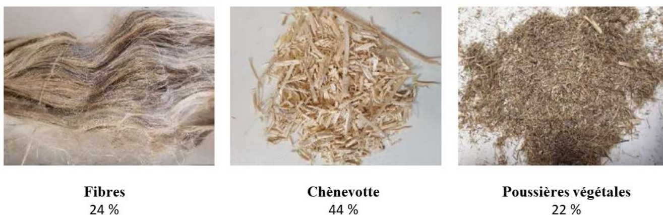
Figure 1-4 : Fractions végétales obtenues après la première transformation des pailles de chanvre [16,19]
