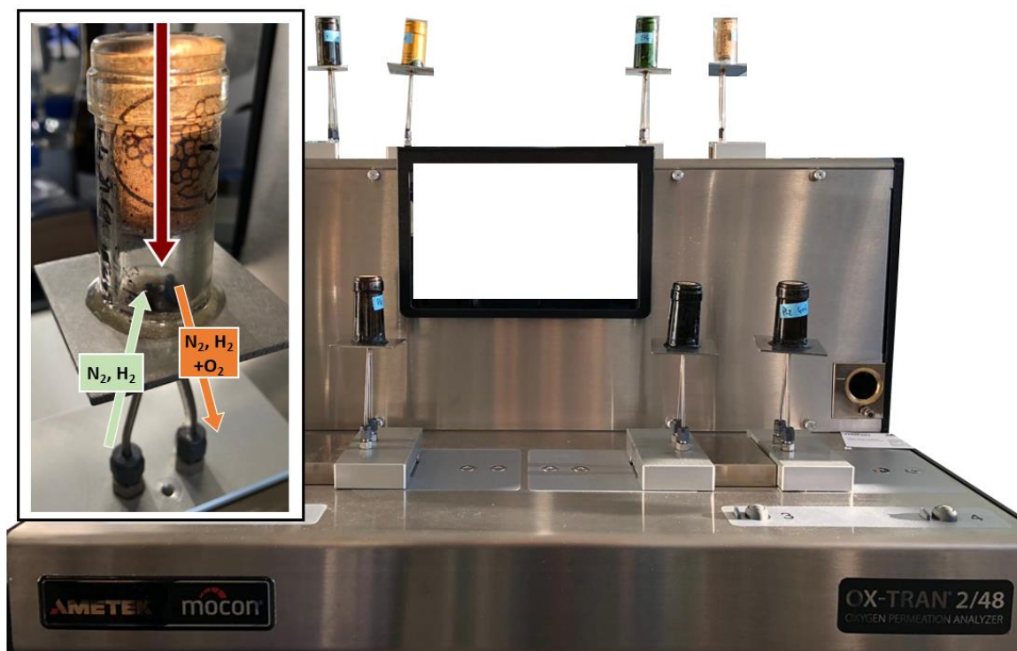
Figure 14. Représentation du système MOCON OX-TRAN 2/48 utilisé pour la mesure de l'OTR des obturateurs par coulométrie.
