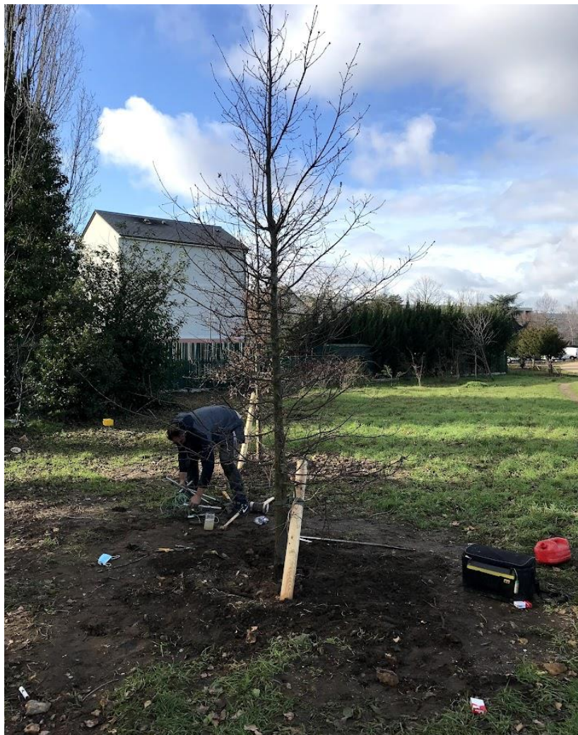
Figure 4. 3 : Installation du dispositif des sondes tensiométriques au pied d'un arbre ( Quercus robur ) nouvellement transplanté dans un parc situé à Chatou en Ile de France (arbre transplanté en décembre 2020, dispositif installé le 22/01/2021 par Kosso SENE et Anass Bentham, technicien à Urbasense)
