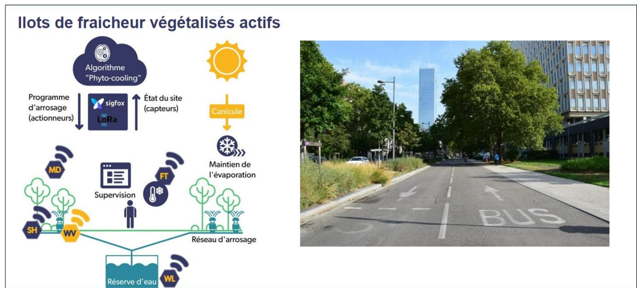
Figure Annexe 3 : Schéma du dispositif expérimental sur la rue Garibaldi, WL : réserve d'eau, SH : sondes tensiométriques, MD : capteurs dendrométriques, FT : mini station météo
