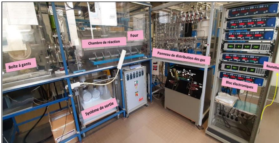
Figure 1.37 : dispositif expérimental du réacteur HVPE
