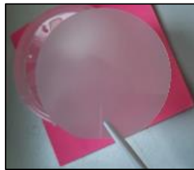
Figure 1.47 : Plaquette 2 pouces de substrat GaN/ Al 2 O 3 avant utilisation.
