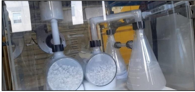
Figure 1.40 : Système de sortie et récupération des gaz à la sortie du réacteur.
