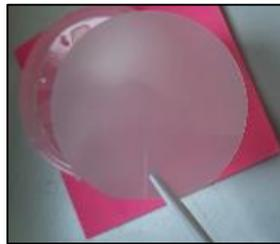
Figure 1.47 : Plaquette 2 pouces de substrat GaN/ Al<sub>2</sub>O<sub>3</sub> avant utilisation.
