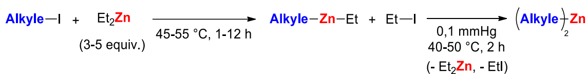
Schéma I-4 : Préparation de composés dialkylzinciques fonctionnalisés via une méthode d'échange iodure/zinc.
