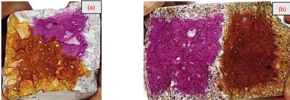
Figure 26- Eprouvettes de béton (a) et de mortier (b) utilisées pour tester deux indicateurs colorés , solution de curcumine 0,5 % (jaune) et solution de phénolphtaléine 1,0 % (rose) (Chinchón-Payá et al., 2016)
