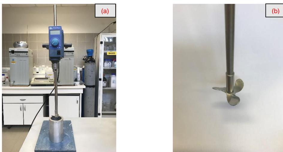
Figure 178- Ensemble de l'agitateur (a) et palette en hélice (b) utilisés pour la fabrication de la pâte
