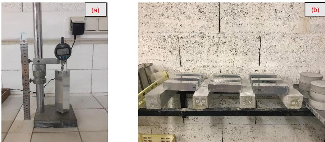
Figure 59- Rétractomètre pour la mesure du retrait (a) et les éprouvettes de retrait endogène pendant la conservation (b)
