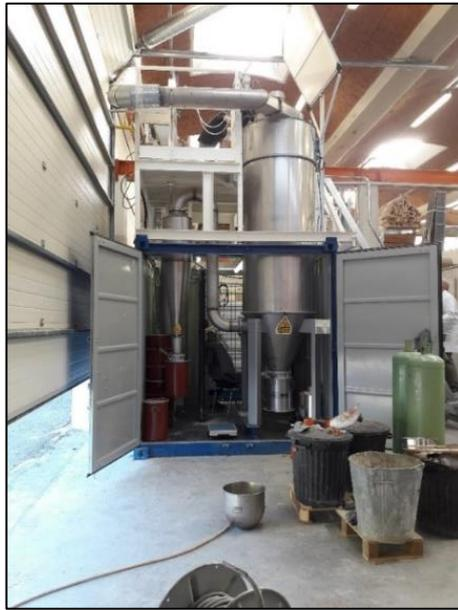
Figure 35- Four flash utilisé
