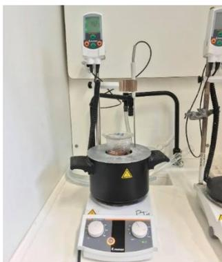
Figure 44- Agitation dans un bain d'eau chaude à 80 °C
