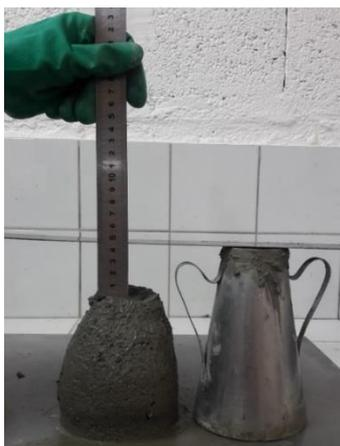
Figure 53- Mesure de l'affaissement du mortier frais par le petit cône d'Abrams
