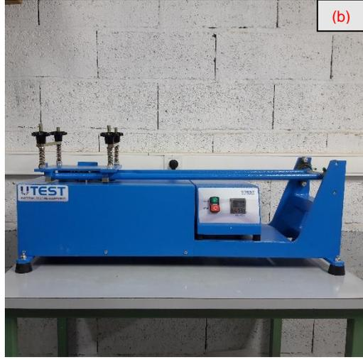
Figure 179- Malaxeur (a) et la table à choc (b) utilisés pour la fabrication et la mise en place du mortier
