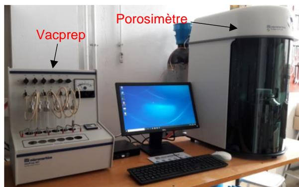
Figure 40- Ensemble de porosimètre Tristar II PLUS et le vacprep 061
