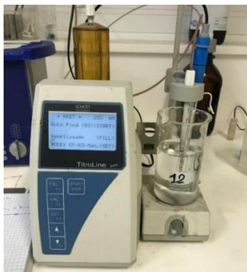
Figure 43- Appareil de titrage potentiométrique utilisé pour le dosage des chlorures
