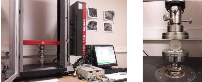
Figure 57- Dispositif Zwick 10 kN pour essai de traction par fendage
