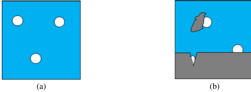
Figure 2.4 – Les différents régimes de nucléation (a) homogène et (b) hétérogène [83]
