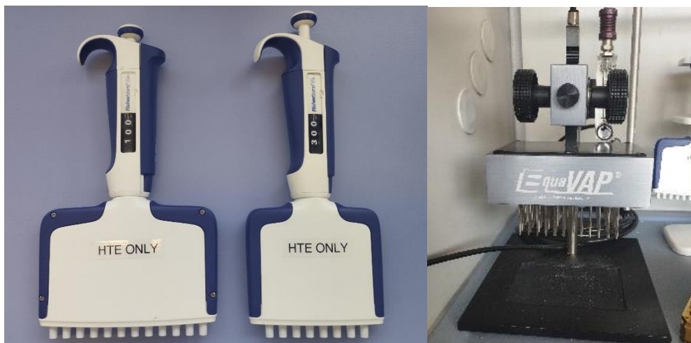
Figure I. 8. Pipettes 12 et 8 multicanaux (gauche) ; Evaporateur 96 puits, EquaVAP (droite).
