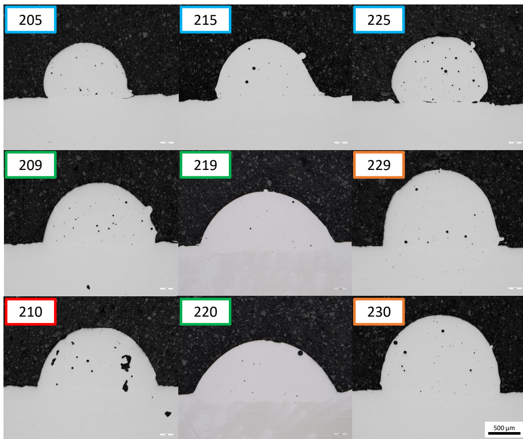
FIGURE 3.3 – Influence de la paramétrie sur la présence de défauts dans les cordons de PASC0-01 (microscopie optique sans attaque). Les références des échantillons correspondent aux références des jeux de paramètres du Tableau 3.3. Les jeux de paramètres en bleu, orange, rouge et vert correspondent à des cordons ayant respectivement un manque d'adhérence avec le substrat, un angle de mouillage inférieur à 110^\circ , des surfusions ou de bonnes caractéristiques morphologiques.
