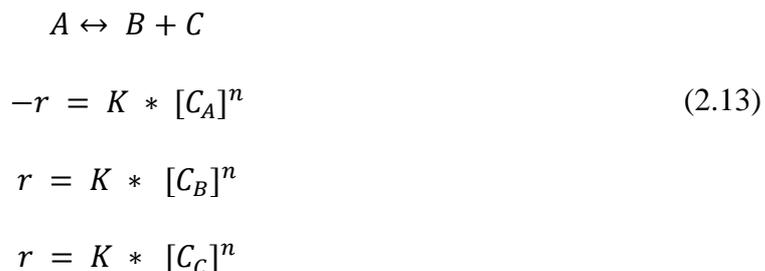
Où  $K$  est la constante de vitesse et  $n$  est l'ordre de la réaction. De cette façon, l'équation de la vitesse de réaction peut être écrite comme suit :
