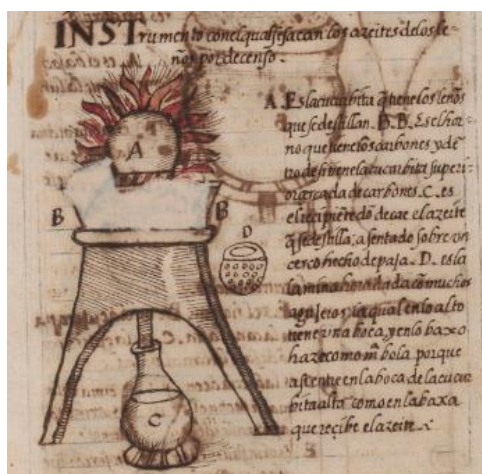
Figure 17 : instrument destiné à produire des huiles essentielles grâce à leur poids relatif ; ce processus est connu sous le nom de distillation par déclin.
