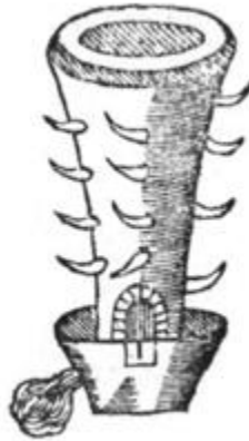
Figure 1 : Illustration d'une Huayrachina par Álvaro Alonso Barba, présentée dans le chapitre VI du livre IV de son Arte de los metales .
