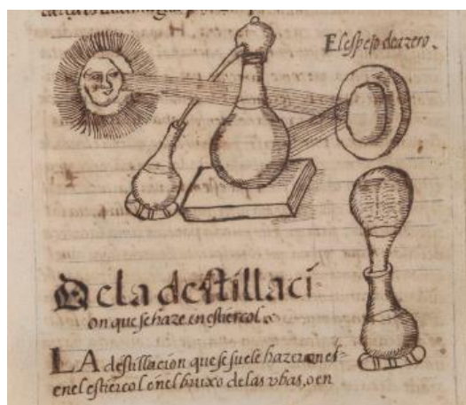
Figure 16 : Deux instruments, celui en haut de l'image est un alambic pour distiller avec la chaleur solaire, celui d'en bas fonctionne avec la chaleur produite par le fumier.
