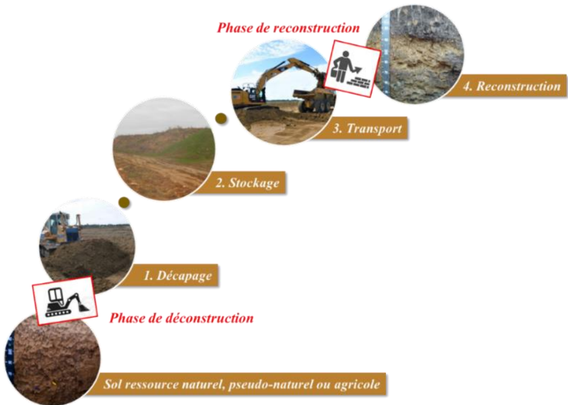
Figure 2 – Etapes du processus d'ingénierie pédologique de reconstruction de sol dans le cadre d'un projet d'aménagement paysager
