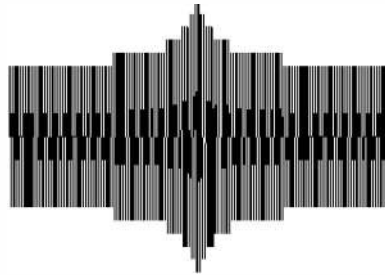
fig. 6.3 : Bloc de chargement appliqué lors des essais
