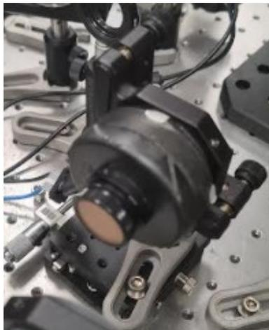
Figure III.18. Image montrant une photographie du diffuseur rotatif.
