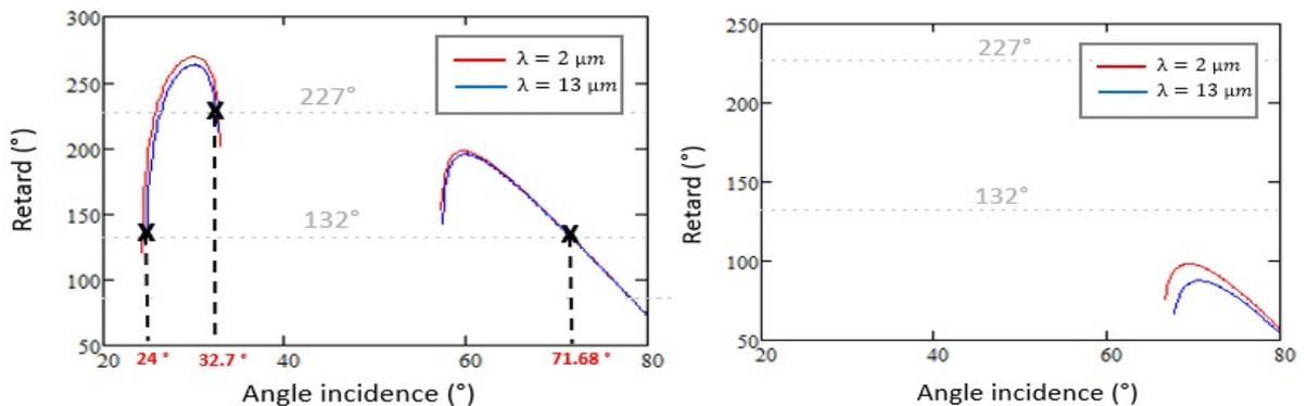
Figure II.14. Retard en fonction de l'angle de réflexion interne pour la forme numéro 2, AC, représentée sur la figure II.12 en ZnSe (gauche) ou en BaF<sub>2</sub> (droite). En rouge et bleue des simulations à des longueurs d'onde de 2 et 13 μm respectivement.
