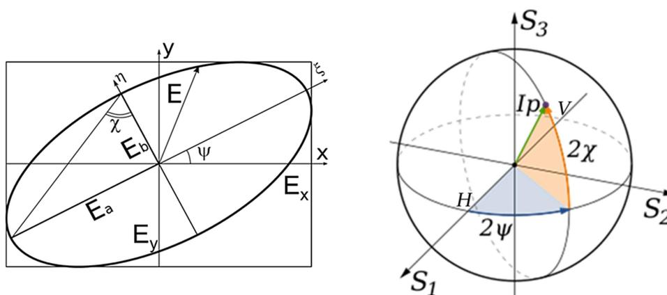
Figure I.4. A droite, ellipse de polarisation montrant les angles représentant son azimut,  $\psi$ , et son ellipticité,  $\chi$ . A gauche, sphère de Poincaré, avec les axes  $S_1$ ,  $S_2$  et  $S_3$ , ainsi que les coordonnées sphériques azimutale et polaire déterminées par l'azimut,  $\psi$ , et d'ellipticité,  $\chi$ . Les états linéaires horizontal, H, et vertical, V, sont aussi représentés.
