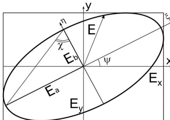
Figure 1.3. Ellipse de polarisation orientée arbitrairement montrant les angles représentant son azimuth,  $\psi$ , et son ellipticité  $\chi$ . Les composantes du champ électrique  $E_x$  et  $E_y$  selon un repère orthogonal canonique et les composantes  $E_a$  et  $E_b$  selon un repère orthogonal parallèle aux axes de l'ellipse sont également représentées.
