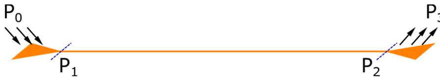
Figure V-26 : Schématisation d'un circuit droit avec différents points de mesures de puissance pour le calcul d'estimation des pertes de propagation dans le bleu.
