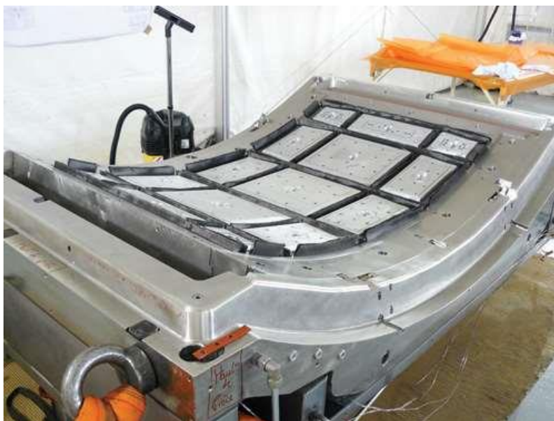
Fig. I.1. Moule de drapage de fibres de carbone pour une porte d'avion [1]
