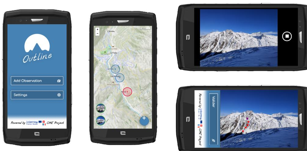
Figure 4.31 – Application Outline pour la prise de photo et le détourage de l'observation
