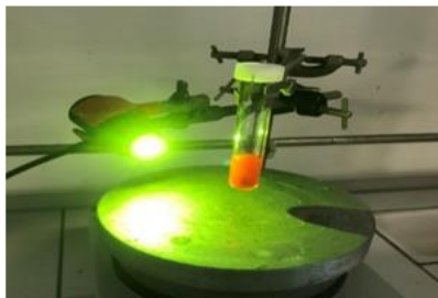
Figure 126 : Montage utilisé pour réaliser les réactions photocatalytiques
