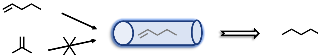
Figure 35: Hydrogénation sélective de 1-butène dans le pore de la Zeolithe A
