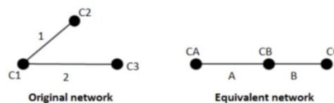
Figure 24 - Agrégation des branches pour la méthode allemande et danoise (Sharif et Hamid, 2016)
