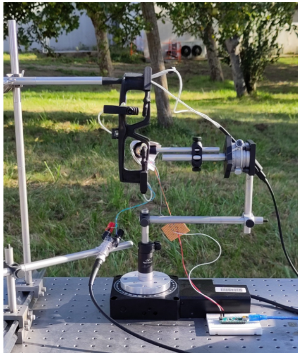
FIGURE 4.6 – Banc de mesure pour la comparaison des oculomètres en extérieur. L'œil artificiel est monté sur les platines rotatives.
