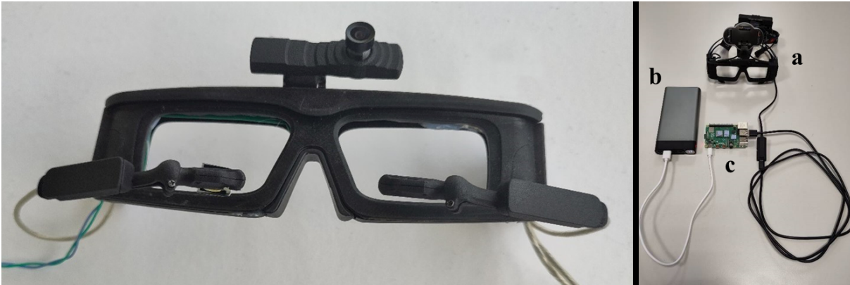
FIGURE 3.9 – Image de gauche : monture de lunettes imprimée en 3D embarquant la bobine primaire et les caméras Pupil Core. Image de droite : Configuration complètement portable de l'oculomètre avec : a) la monture, montée sur un bandeau avec une sangle occipitale pour améliorer la stabilité, b) la batterie du Raspberry Pi et c) un Raspberry Pi 4. Il s'agit de la configuration entièrement portable. Lorsqu'il est connecté à un PC standard, le Raspberry Pi et la batterie ne sont pas nécessaires.
