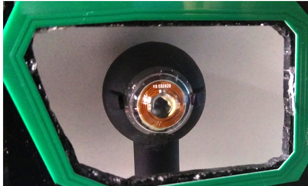
FIGURE 2.7 – Lentille de contact montée sur un œil artificiel.
