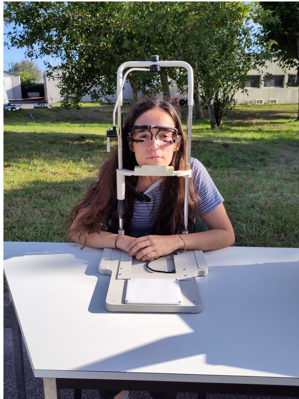
FIGURE 4.3 – Exemple de port sur humain du Pupil Core monté sur sa monture originale, avec une mentonnière.
