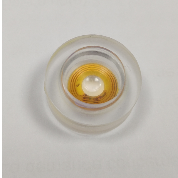
FIGURE 2.2 – Palet de lentille avec un circuit encapsulé, avant son usinage.
