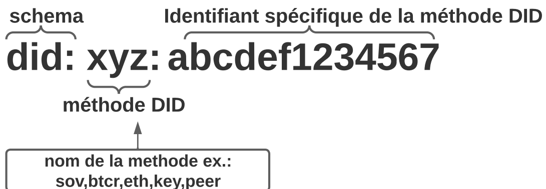
FIGURE 2.2 : Structure d'un identifiant décentralisé (DiD) [69]
