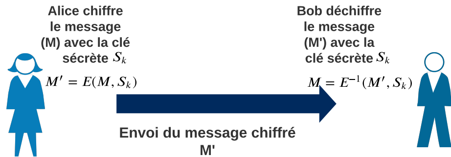
FIGURE 2.3 : Système de cryptographie symétrique
