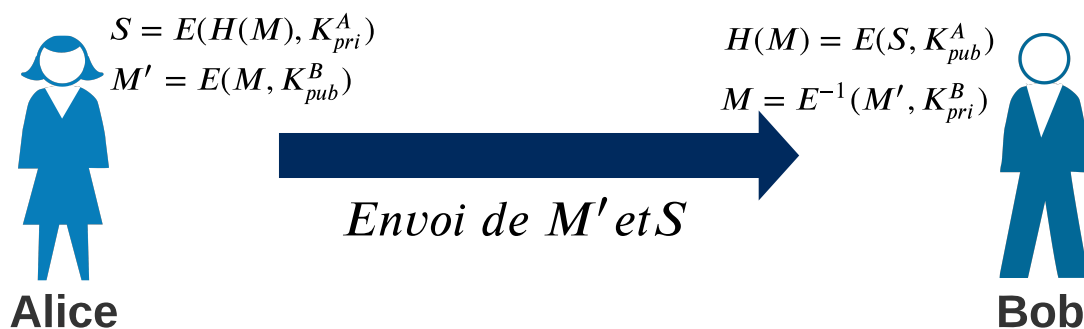
FIGURE 2.5 : Signature numérique associée à la cryptographie asymétrique
