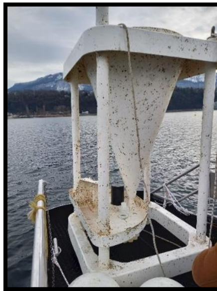
Figure 21 Trappe à sédiments séquentielle installée au lac du Bourget
