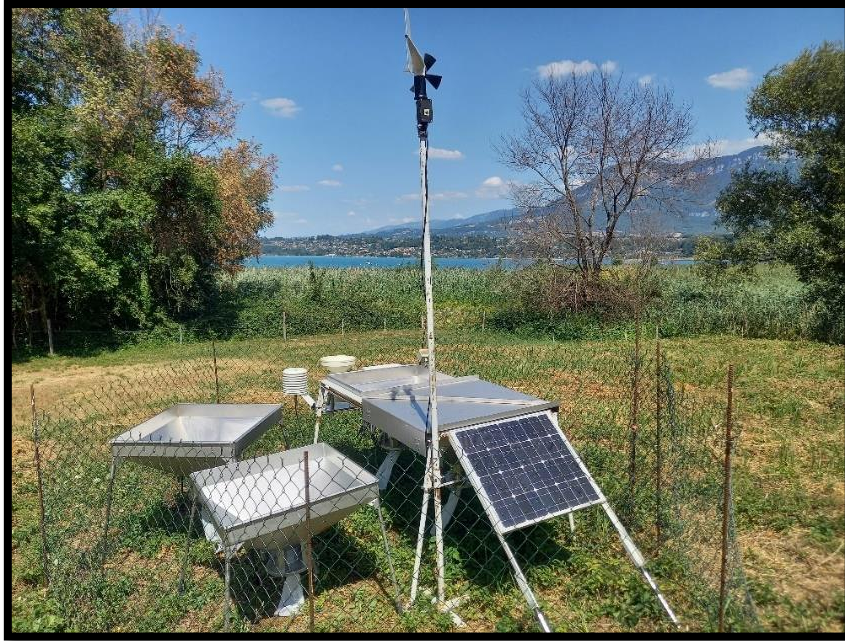
Figure 24 Table atmosphérique installée sur la rive sud du lac du Bourget
