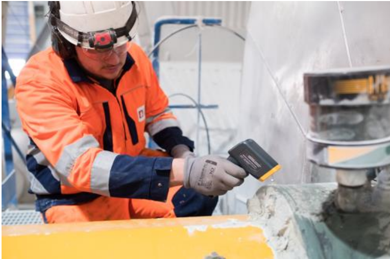
Figure 27 : Prise de température de palier au pistolet laser.
