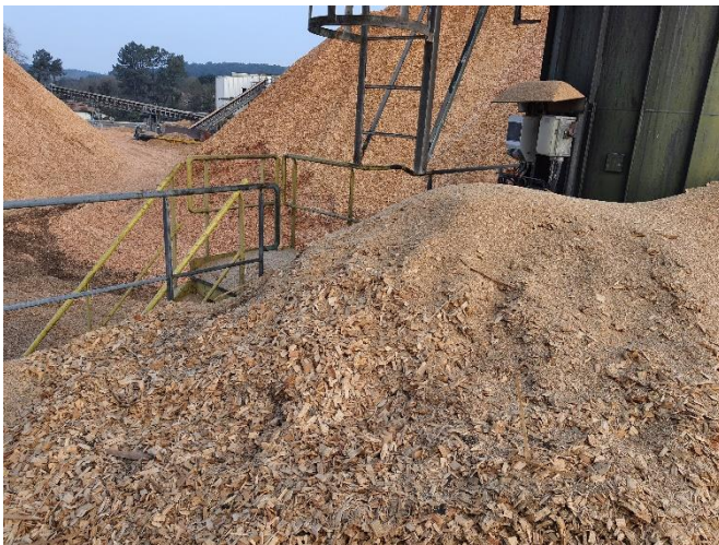
Figure 10 : Des copeaux bloquant les accès
