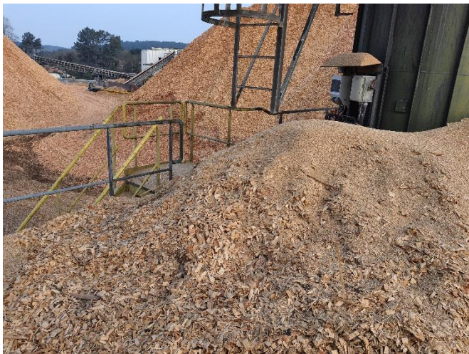
Figure 10 : Des copeaux bloquant les accès
