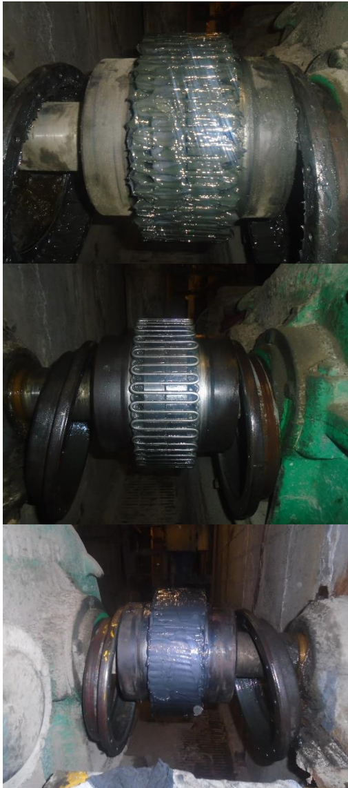
Figure 26 : Les 3 phases de graissage manuel d'un accouplement à ressorts "Citroën"
