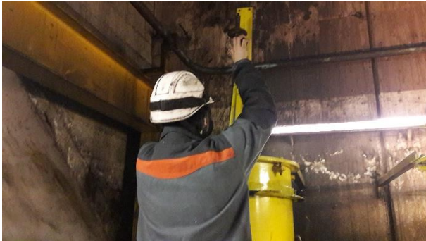
Figure 29 : Mesure de la tige témoin d'un poste Farvall
