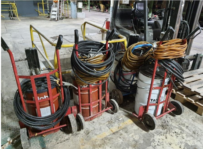
Figure 25 : Cinq chariots de graissage équipés de leurs tuyaux, flexibles et poignées de graissage.
