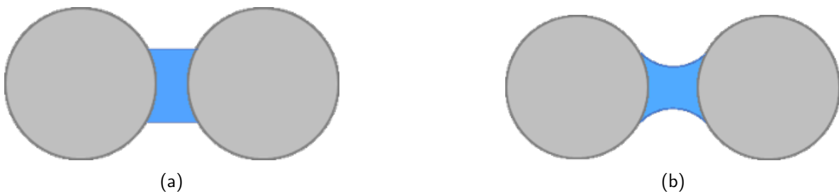
FIGURE 3.7 – Schémas en vue de côté de deux billes reliées par un pont capillaire, (a) : \Delta P_{liq} = 0 Pa et (b) : \Delta P_{liq} < 0 Pa.
