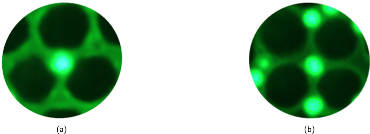
FIGURE 4.16 – Image d'un film granulaire bidisperse de billes de 80 \mu\text{m} et 250 \mu\text{m} de diamètre dans lequel on peut voir les particules de 250 \mu\text{m} se disposer de sorte à former un triangle (a) ou un carré (b) dans lequel une particule de 80 \mu\text{m} vient s'insérer.
