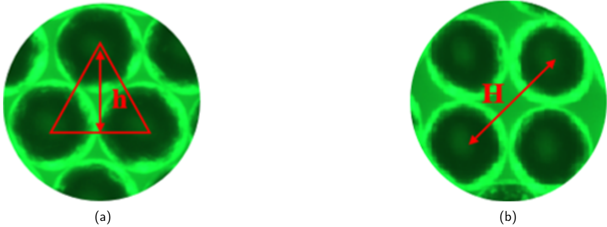
FIGURE 4.15 – Images de régions d'un film granulaire constitué de billes de 141 \mu\text{m} de diamètre en arrangement triangulaire (a) et carré (b).
