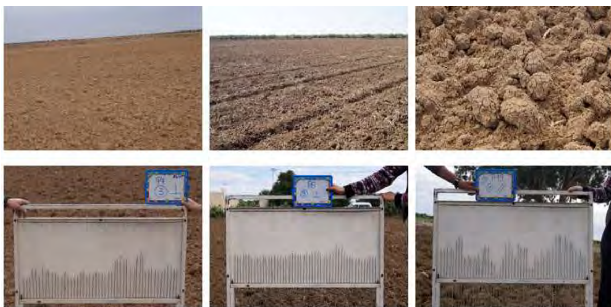
Figure 29. Mesures de rugosité en utilisant le rugosimètre à aiguilles dans les parcelles test.
