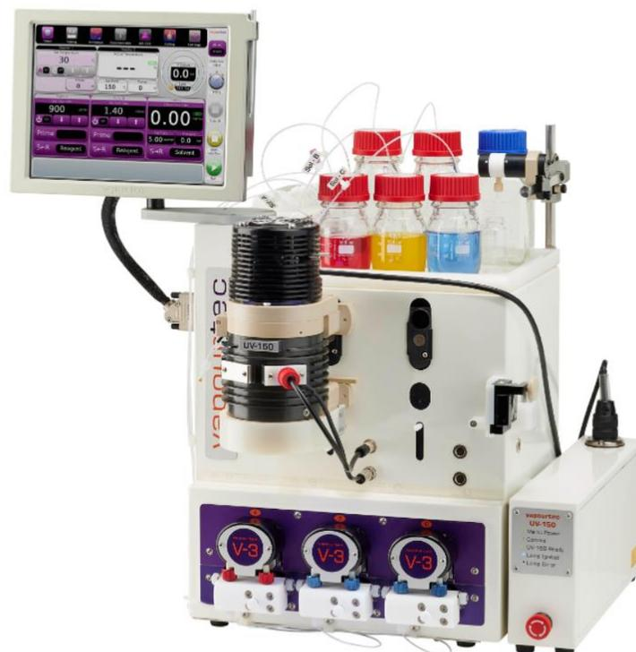
Figure 40 : Réacteur en flux utilisé
