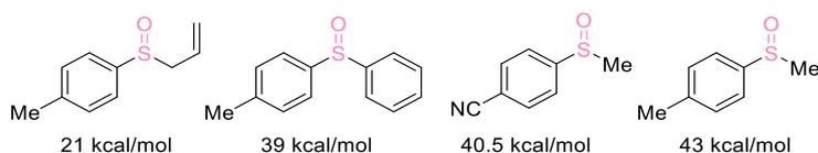
Figure 12 : Énergies d'inversion de quelques sulfoxydes
