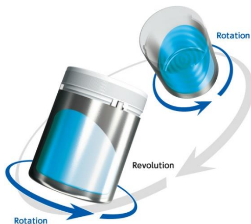
Figure 41 : Principe du mélangeur planétaire centrifugeur (Kakuhunter) 4 .
