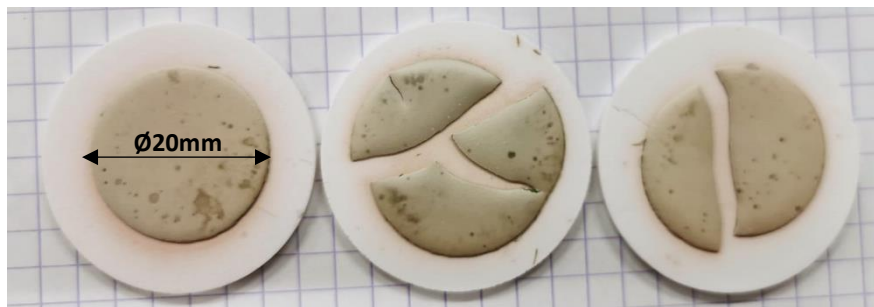
Figure 115 : Demi-cellules anodiques 5 couches après traitement de cofrittage sous charge.
