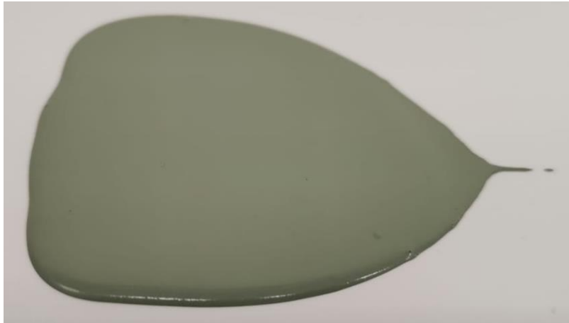
Figure 73 : Barbotine pour l'anode structurale coulée à 2000 \mu\text{m}
