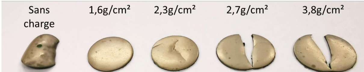
Figure 94 : Image des demi-cellules anodiques multicouches (couche barrière et couche composite incluses) après frittage sans et avec différentes charges de frittage
