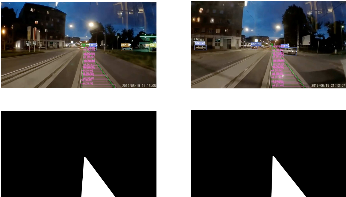
FIGURE 75: Génération d'une forme pour délimiter les RoIs à partir des clusters de la voie de circulation principale et extraction d'un masque
