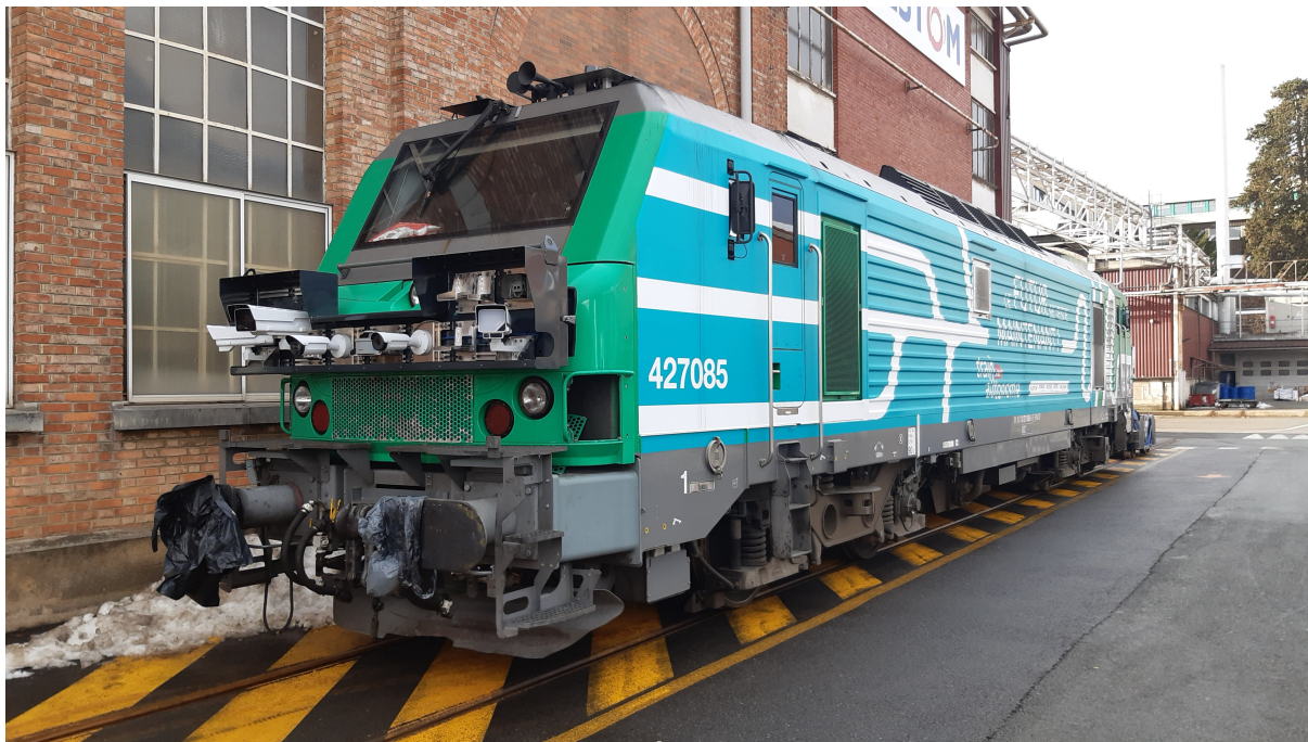
FIGURE 1: Locomotive utilisée sur le projet TFA avec les capteurs montés.
