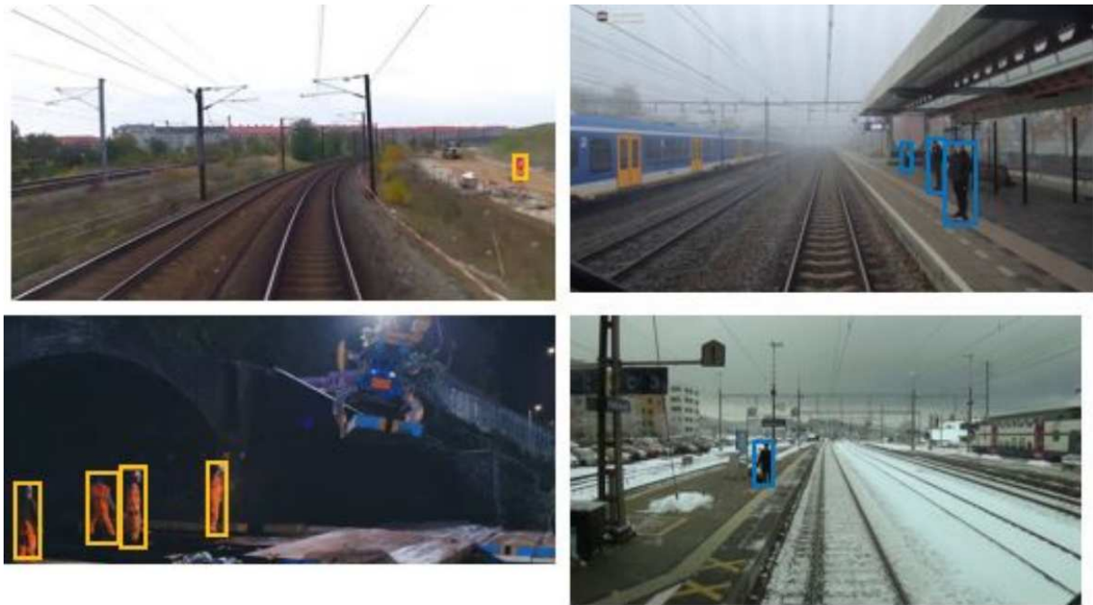
FIGURE 45: Résultat de détection de la méthode proposée sur des scènes ferroviaires avec des voyageurs et des travailleurs [136]
