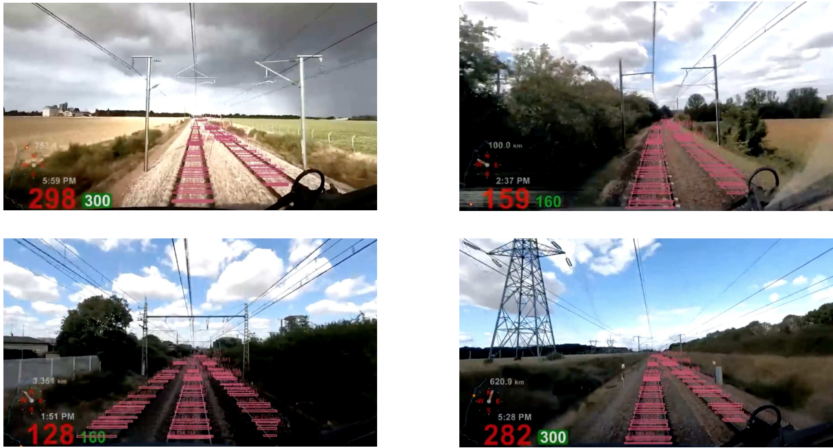
FIGURE 73: Résultats de détection du modèle YOLOV3-Tiny sur une vidéo tout le long du trajet Toulouse Matabiau - Paris Montparnasse.
