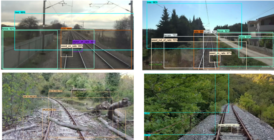
FIGURE 35: Résultats de détection basée sur UAVs [106]
