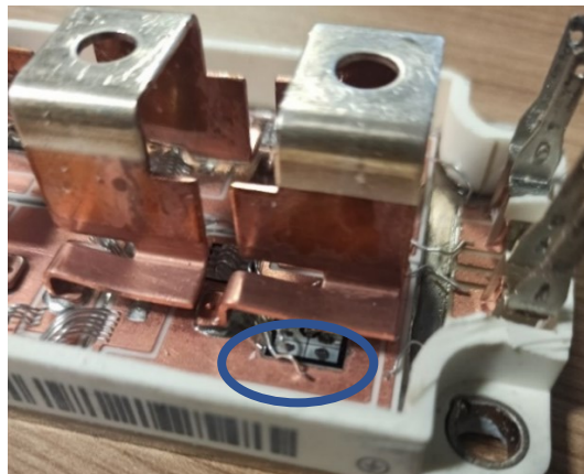
Figure A.37. Analyse post-mortem du module
