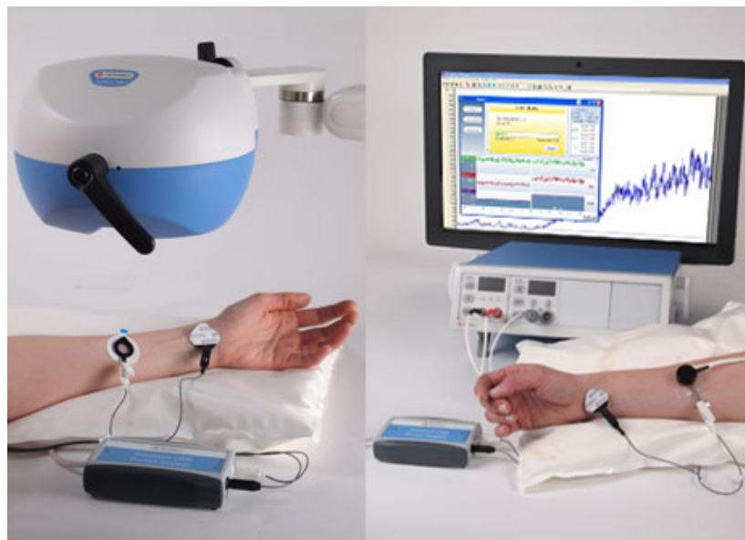
Figure 27 - Montage d'iontophorèse monitoré par LSCI. D'après http://www.perimed-instruments.com/fr/iontophorese
