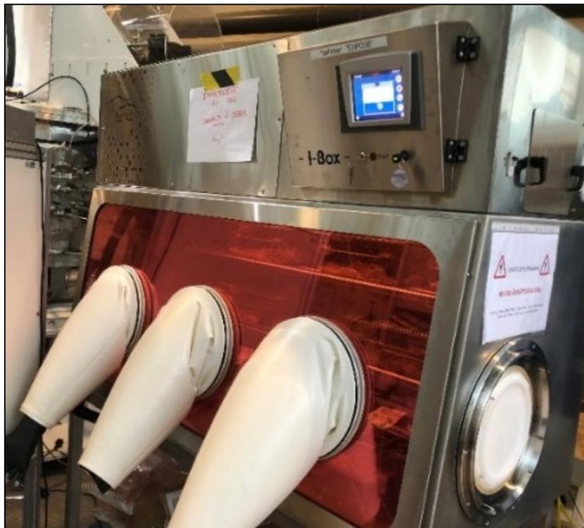
**Figure 21** - Vue d'un dispositif d'exposition (isolateur) utilisé pour héberger les modèles murins.
