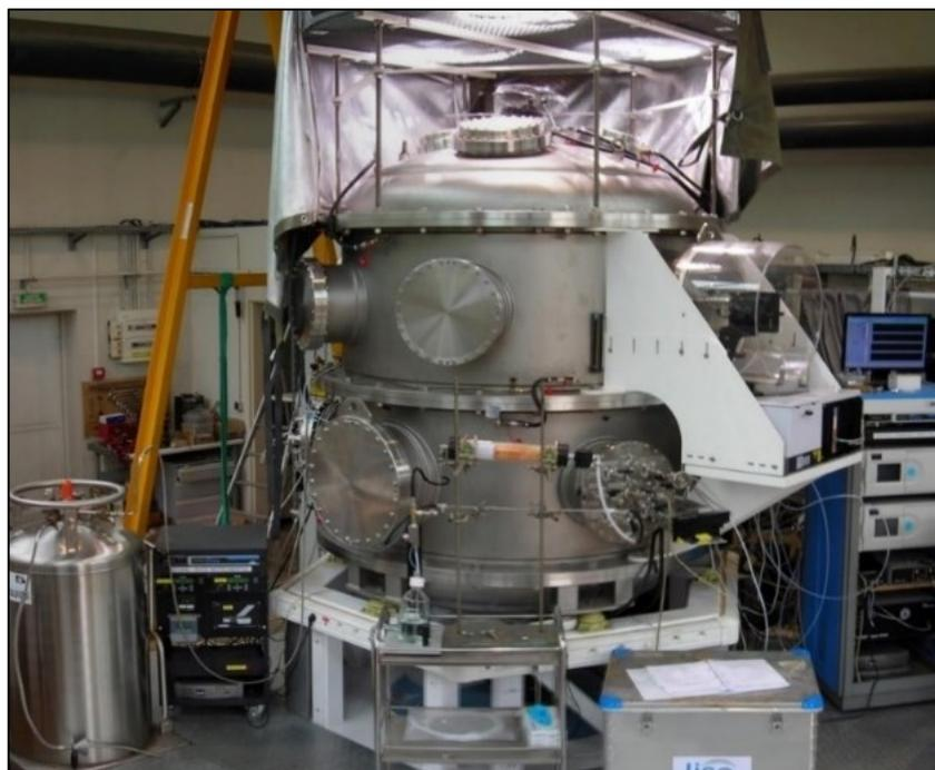
**Figure 16** - Vue de la chambre de simulation CESAM utilisée pour générer des atmosphères.
