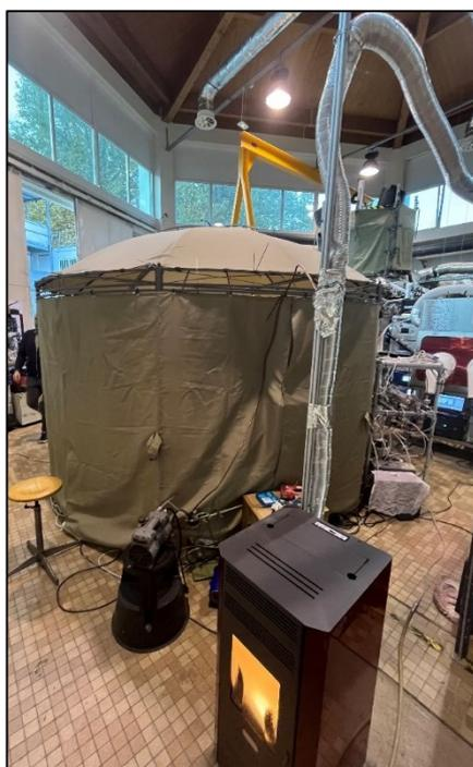
**Figure 58** - Système de combustion (brûleur) des granulés connecté à la chambre de simulation FORTH.
