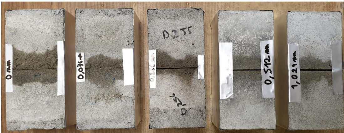
Figure III.2 : Différentes tailles (45, 100, 250, 500 et 1000 \mu\text{m} ) de fissures contrôlées réalisées.
