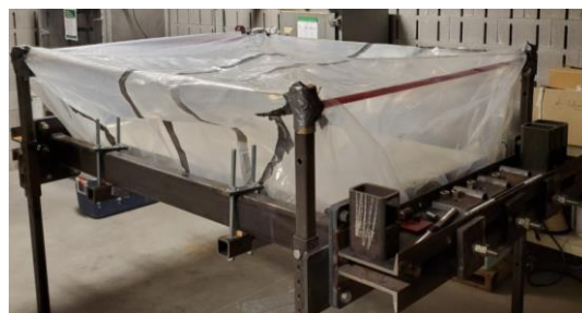
Figure VI.9 : Tente de carbonatation de la dalle.
