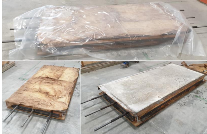
Figure VI.6 : Dalle de béton dans son coffrage pendant sa cure humide.
