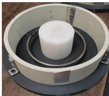
Figure VI.2 : Moule d'une éprouvette de mortier avec armature d'acier suspendue par des fils en nylon.
