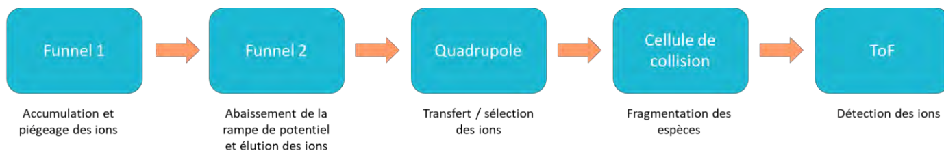
Figure 49 Schéma de l'architecture du spectromètre de masse TIMS ToF
