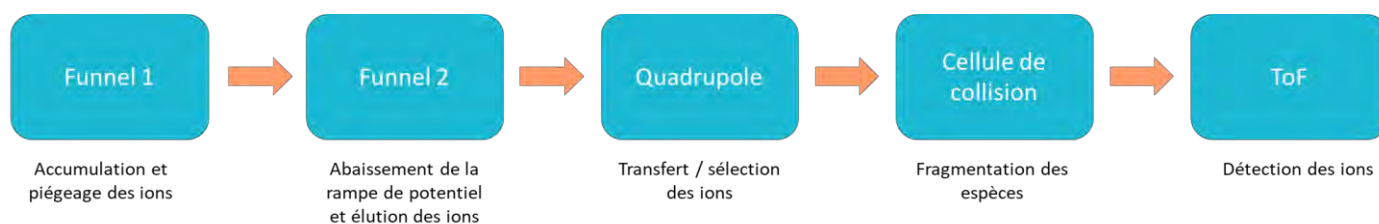
Figure 49 Schéma de l'architecture du spectromètre de masse TIMS ToF
