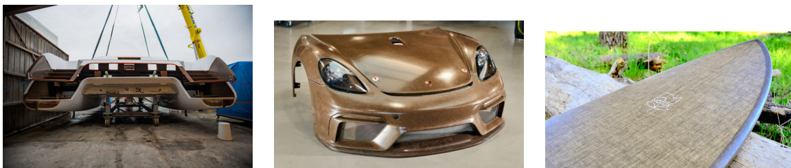
FIGURE 1.1 – Exemples d'applications industrielles des fibres techniques de lin : à gauche, le catamaran We explore qui possède la plus longue pièce en lin technique jamais fabriquée (2022); au milieu, panneaux de carrosserie de Porsche (2020); à droite une planche de surf 100% biosourcée (2016)
