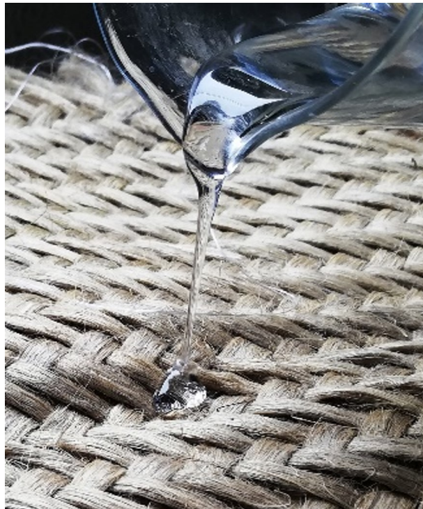
FIGURE 2.1 – Imprégnation des fibres de le lin par un mélange époxy-amine, image d'illustration
