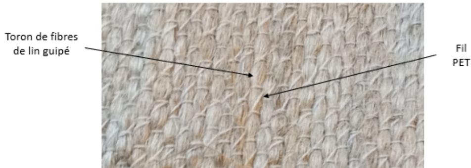
FIGURE 2.3 – Torons de fibres de lin non torsadées et guipés au PET
