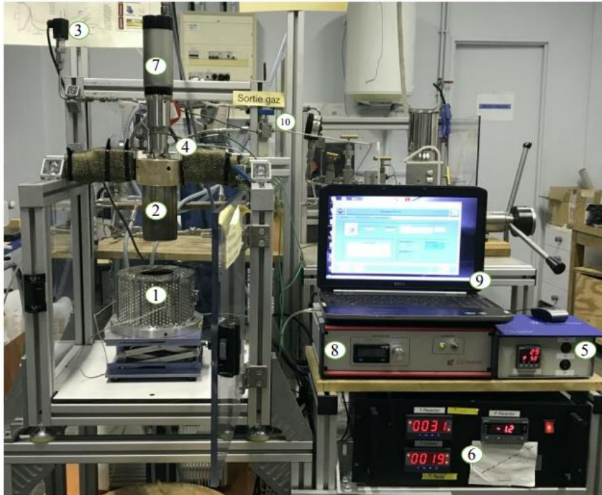
Figure III-3 Dispositif expérimental du réacteur autoclave agité 300 mL [1]
