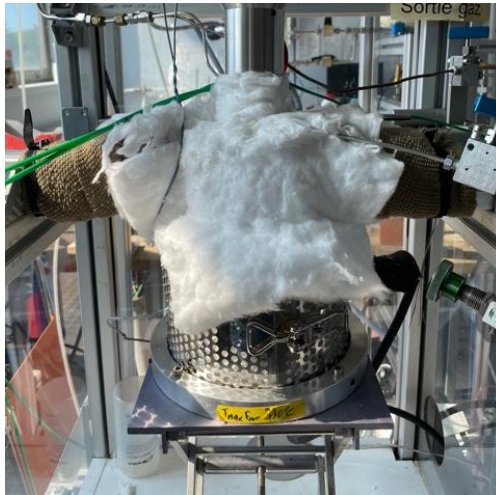
Figure B- 4 Photo du réacteur avec isolation
