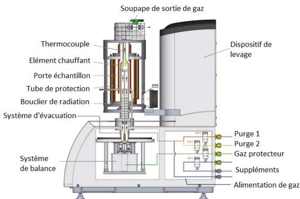
**Figure C-1** Schéma de l'analyseur STA 449 F3 de Netzsch
