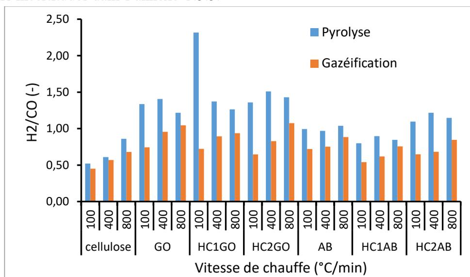
**Figure IV-18** Ratio H<sub>2</sub>/CO du gaz produit lors de la pyrolyse et la gazéification de tous les échantillons à différentes vitesses de chauffe
