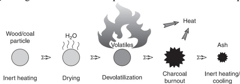
**Figure I-6** Processus de combustion à l'échelle d'une particule [41]
