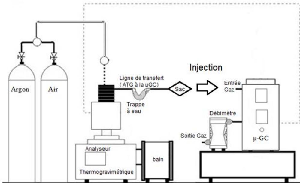
**Figure IV-1** Dispositif expérimental du couplage ATG- $\mu$ GC
