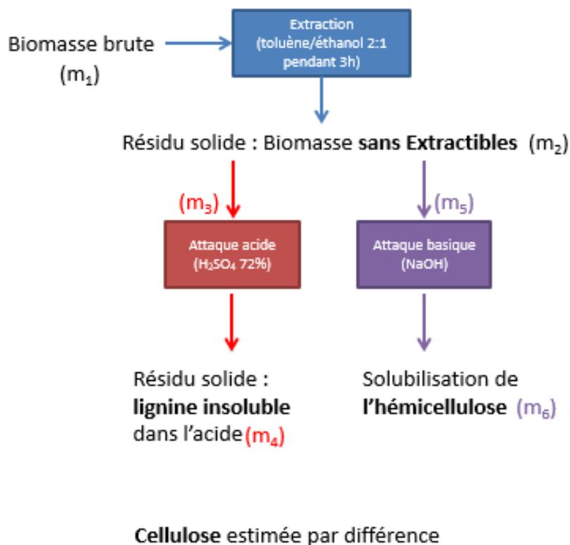
Figure II-3 Schéma descriptif de la méthode de Collard
