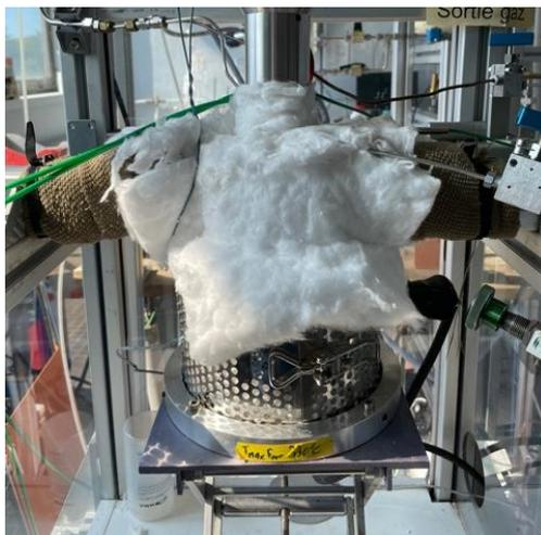
**Figure B- 4** Photo du réacteur avec isolation
