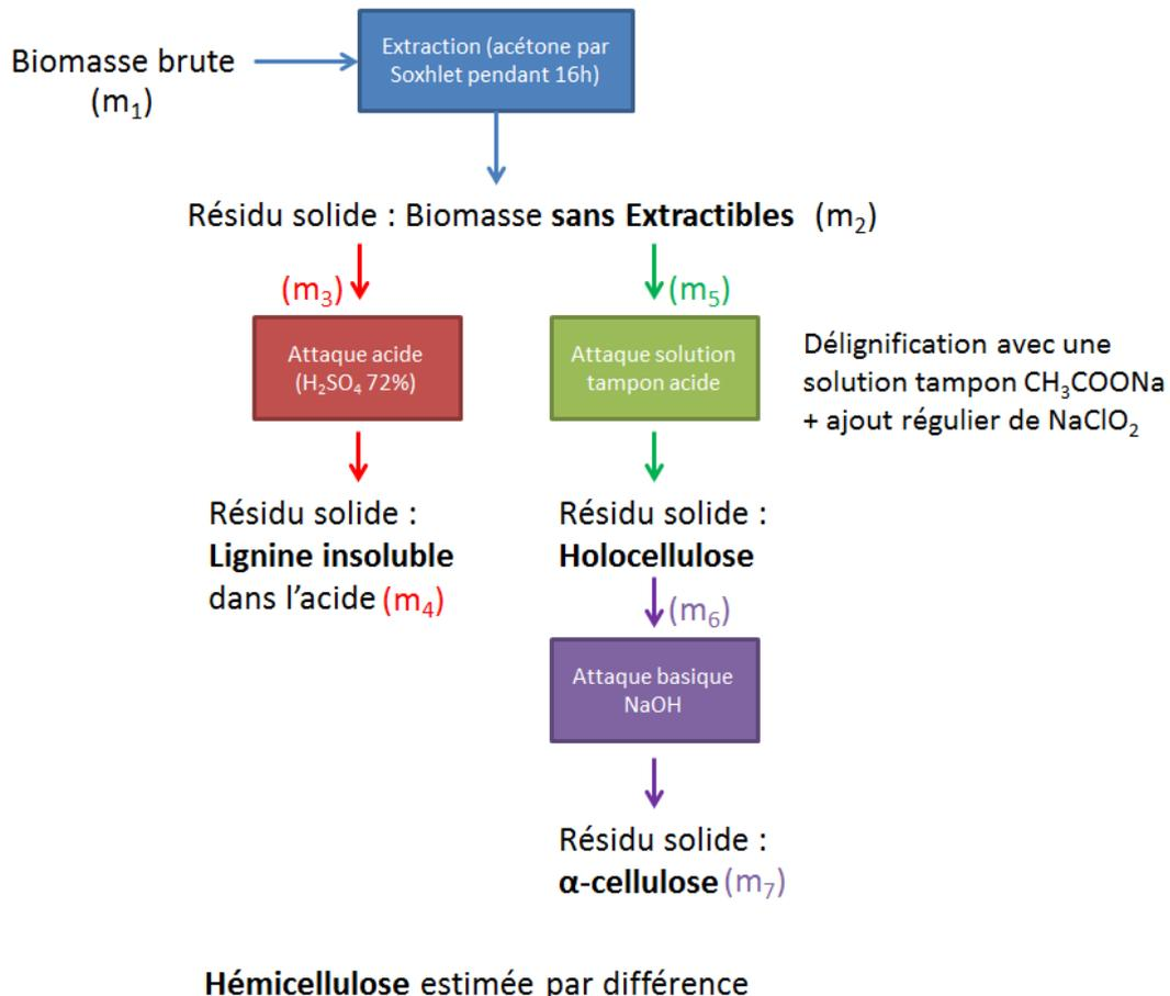
Figure II-2 Schéma descriptif de la méthode de Carrier-Malardier
