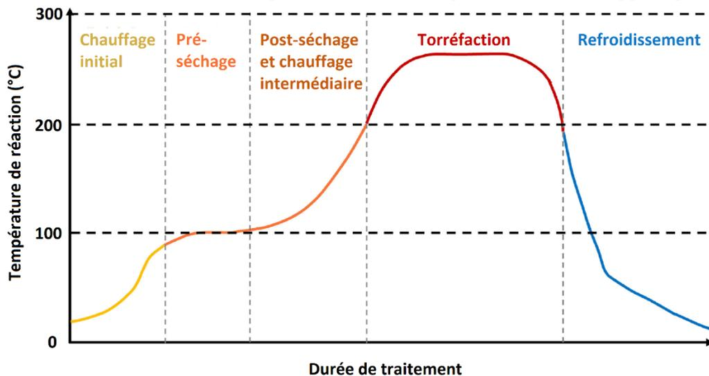
**Figure I-11** Schéma des différentes étapes de la torréfaction [40]
