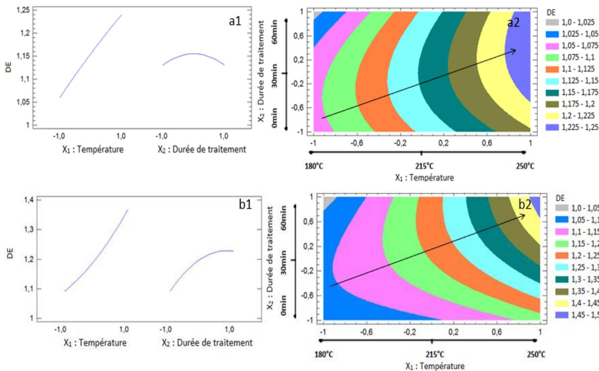
**Figure III-14** Effet de la température ( $X_1$ ) et de la durée de traitement ( $X_2$ ) sur DE (a1 : GO, b1 : AB) et les tracés de contour 2D correspondants (a2 : GO, b2 : AB)
