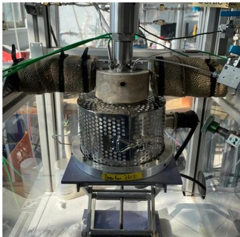
Figure B- 3 Photo du réacteur sans isolation
