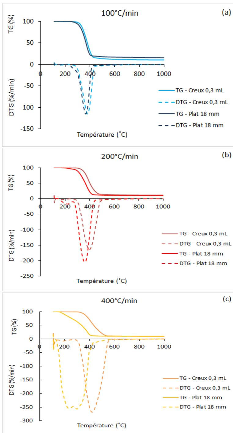
**Figure IV-4** Courbes TG et DTG comparant la pyrolyse de la cellulose en utilisant deux géométries différents de creuset à 100°C/min (a), 200°C/min (b) et 400°C/min (c)
